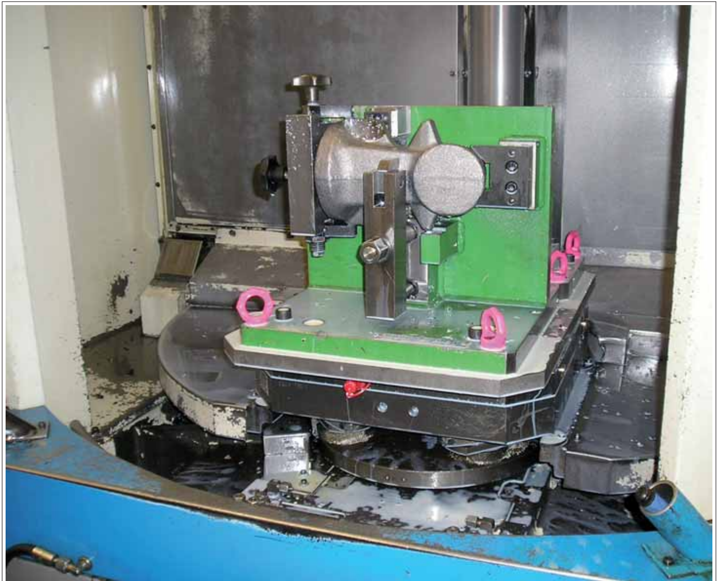
Schneller Vorrichtungswchsel dank des AMF-Zero-Point-Systems zur Bearbeitung von Gussteilen.
