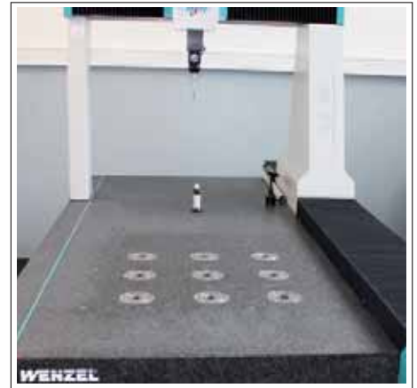
AMF-Zero-Point-System integriert in einer Messmaschine
