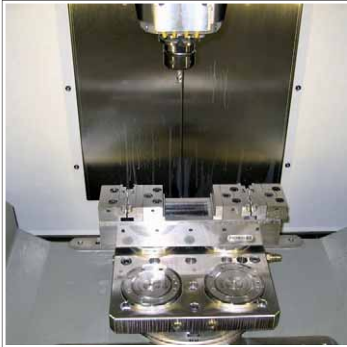
Vielseitiger Einsatzbereich mit Hilfe des AMF-Zero-Point-Systems. Nicht verwendete Spannmodule werden mit einem Schutzknippel vor Verschmutzung geschützt.
