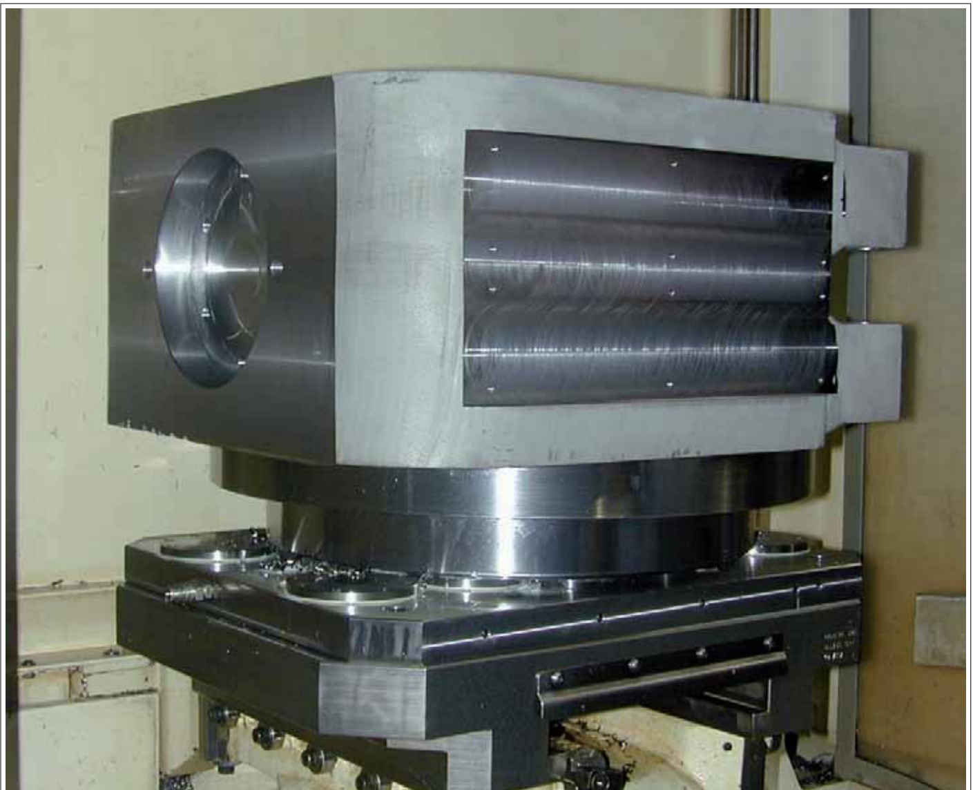
Große Werkstücke können problemlos gespannt werden. Für den Einsatz bei schwerster Zerspanung an fünf Seiten ist das AMF-Zero-Point-System bestens geeignet.
